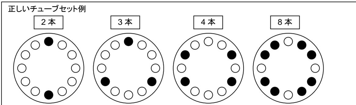
※チューブを対称にセットしないと回転中に振動が発生し故障の原因となります。
